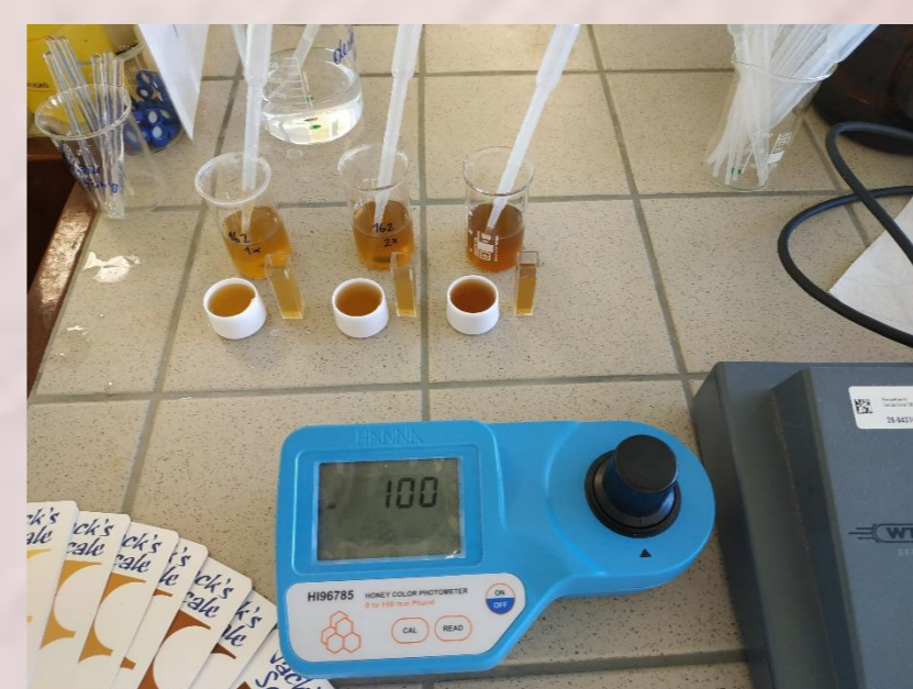
Obrázek 4 Měření barvy medu pomocí fotometru foto: autoři
