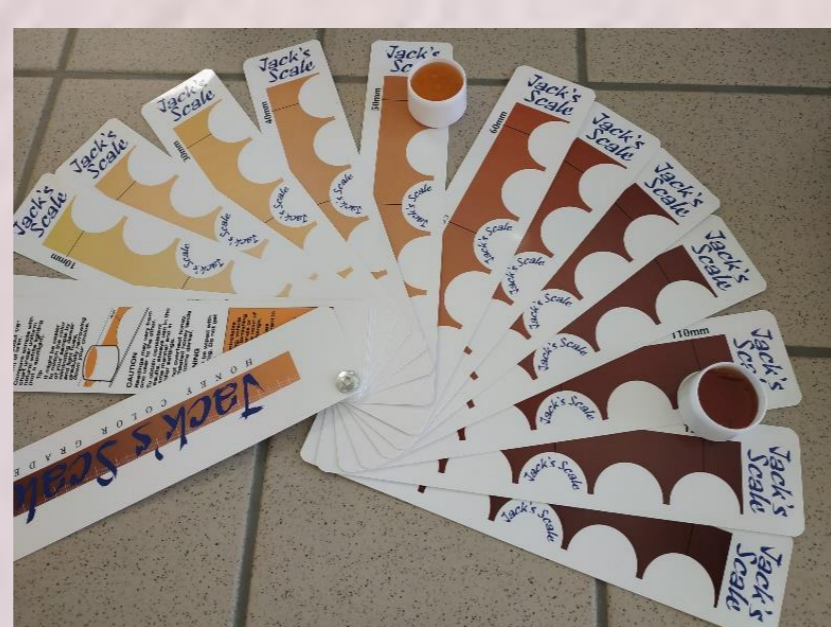
Obrázek 3 Měření barvy medu pomocí stupnice Jack's Scale foto: autoři
