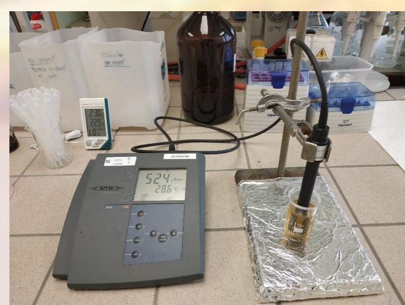
Obrázek 1 Měření elektrické vodivosti medu foto: autoři
