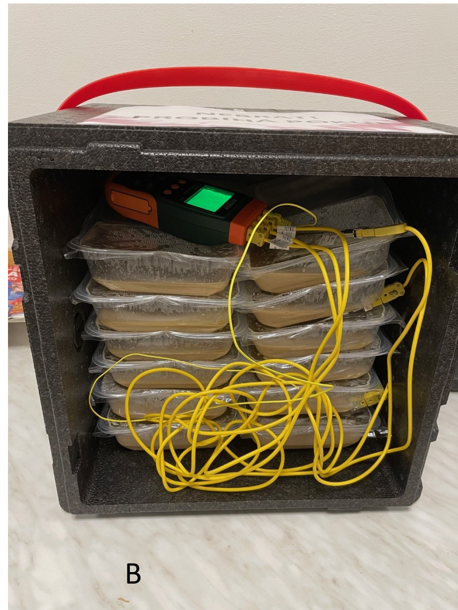
Obr. 3 A: Datalogger s čidly, B: PP termoizolační box naplněný PP zatavenými miskami s čidly dataloggeru
