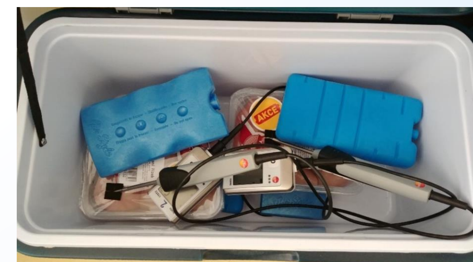
Obr.: Ukázka uložení vzorků v přepravním boxu - vložky pod a nad vzorkem
