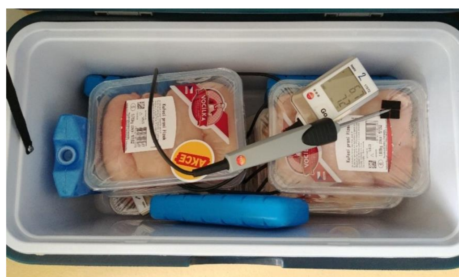
Obr.: Ukázka uložení vzorků v přepravním boxu - vložky po bocích
